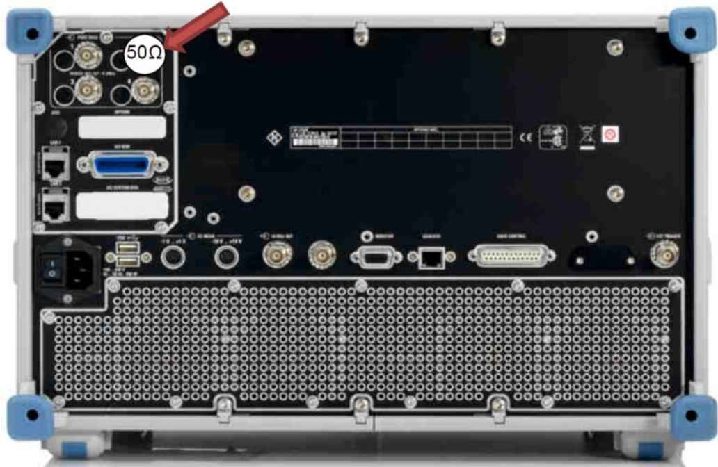
Рисунок 11 – Подключите 50 Ом согласующую нагрузку к инжектору питания (к обозначенному меткой разъему). В этом случае защита обеспечена только для порта 2.
